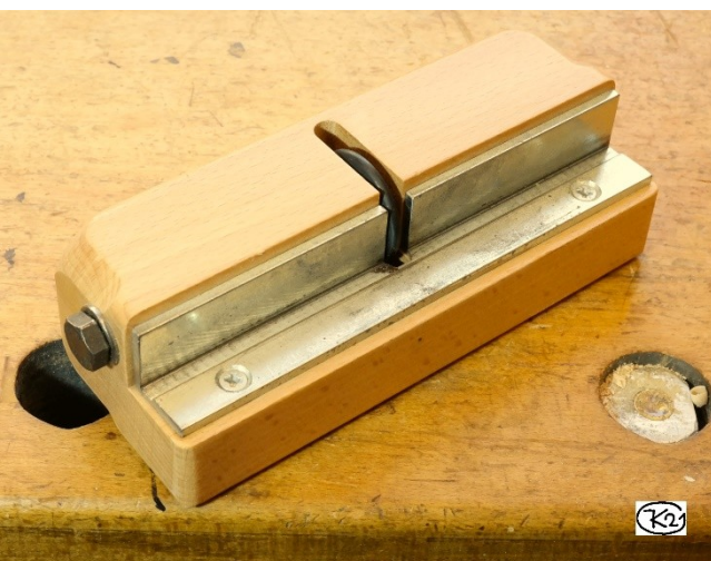
Figure 30: Ulmia card scraper burnisher ("Ziehklingengratzieher")
